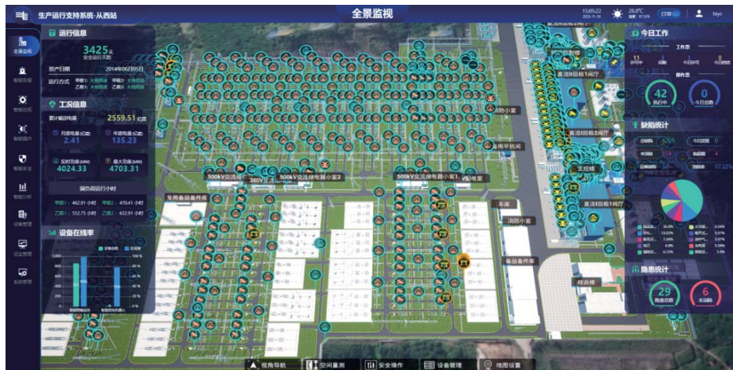
图5 换流站现场智能摄像头布置三维示意图
